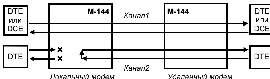
Рис. 24. Пример организации проверки в режиме DL - «цифровой шлейф» для канала 2
