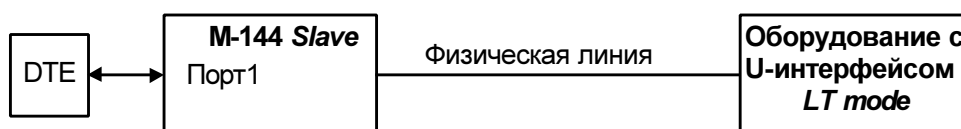
Рис. 37. Работа модема M-144 совместно с LT оборудованием
