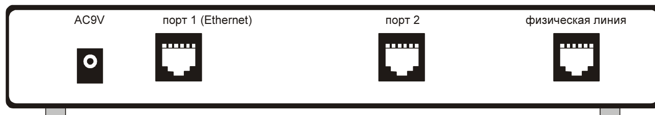
Рис. 3. Задняя панель модема
